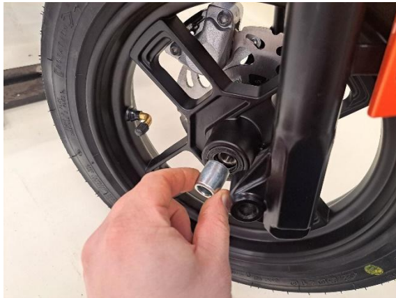
Laita pitempi holkki etupyörään paikoilleen.
