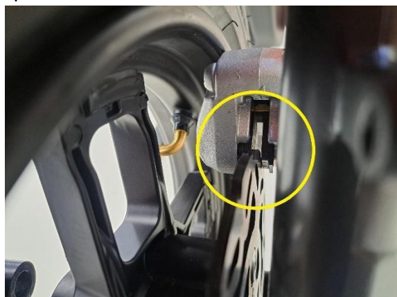
Katso, että jarrulevy asettuu etujarrupalojen väliin.
