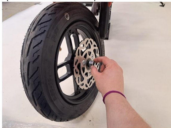
Laita lyhyempi holkki etupyörään jarrulevyn puolelle.
