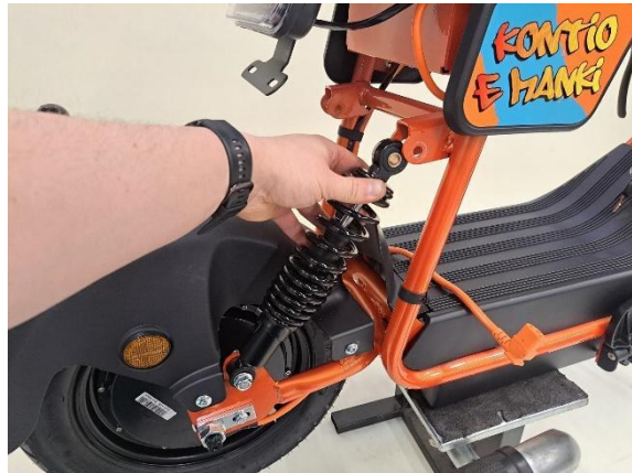
Laita takajousien yläpäätkä paikoilleen.
