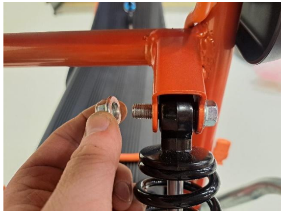
Kiinnitä takajousien kiinnitysmutteri (kiintoavain 14mm)
