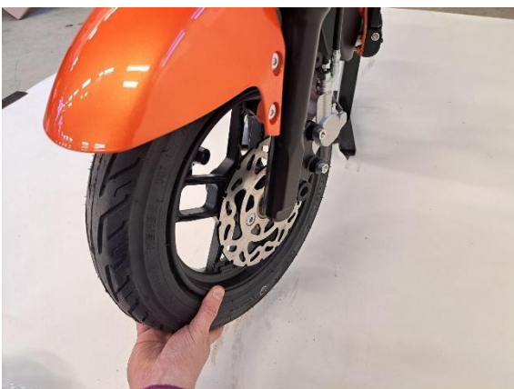
Nosta etupyörä paikoilleen.
