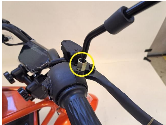
Oikean asennon löydyttyä kiristä mutterit (kiintoavain 14mm). Laita suojat muttereiden päälle.
