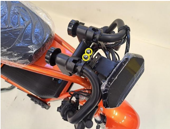
Irroita mittariston kiinnityspultit (kuusiokoloavain 5mm).
