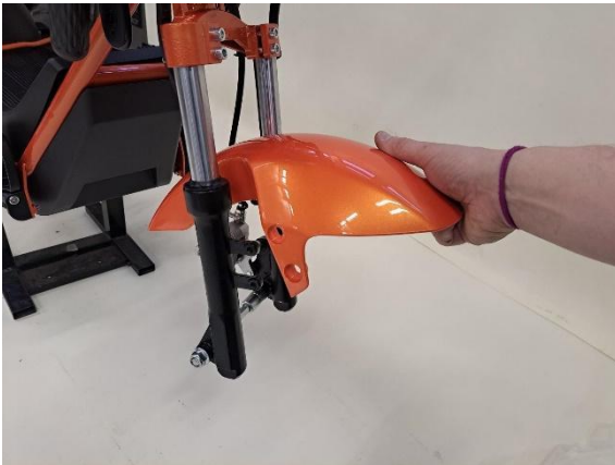
Laita etulokasuoja paikoilleen.
