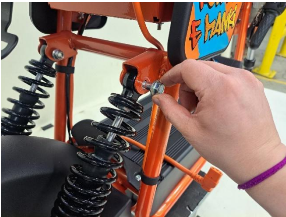
Kiinnitä takajousien yläpäätkä kiinnityspulteilla (kiintoavain 14mm).
