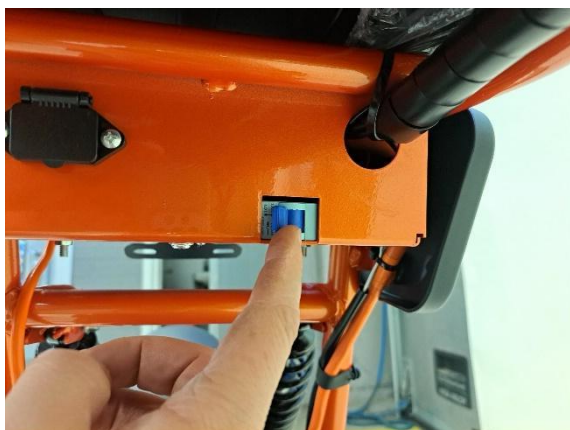
Käännä päävirtakytkin ON-asentoon.
